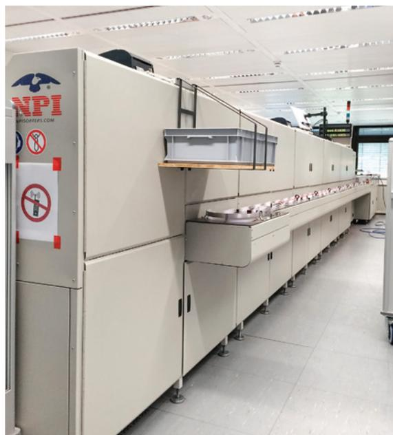
Im Rechenzentrum werden die Rezepte mit großer Geschwindigkeit durch einen Großscanner geführt, mit einem Kennzeichen bedruckt und mehrfach fotografiert.
