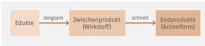
○ Abb. 5.1 Langsamer Reaktionsschritt von Edukten zum Zwischenprodukt und schneller Schritt zu den Endprodukten
