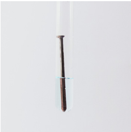
◉ Abb. 14.9 Kupferabscheidung auf einem Eisennagel
