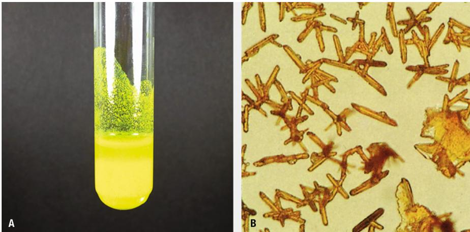
○ **Abb. 14.3**  $PbCrO_4$ : Fällung im Reagenzglas (A) und Mikrokristalle auf Objektträger (B, Vergrößerung: 1 : 100)
