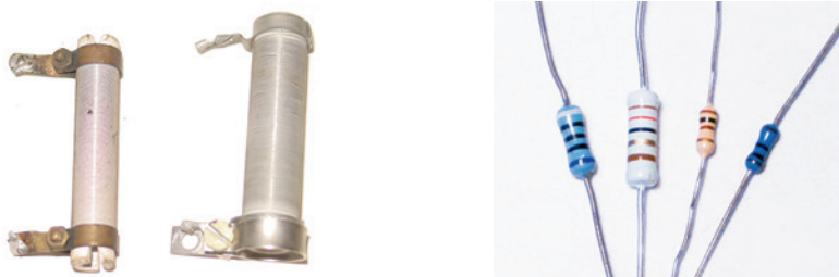
Abb. 2.1 Links: Drahtwiderstände. Rechts: Schichtwiderstände.
