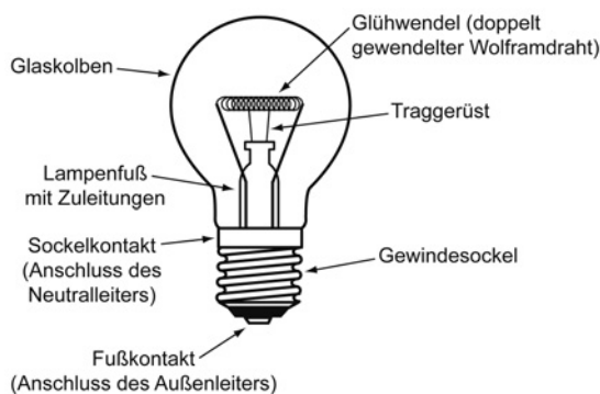
Abb. 9.2 Links: Aufbau einer Standardglühlampe („Glühbirne“). Rechts: Reflektorleuchte.
