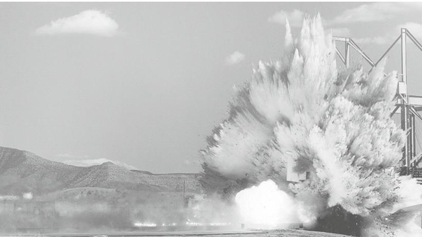
**Abb. 3** Abfolge von drei Bildern vom Aufprall eines F-4-Kampfflugzeugs auf einen Betonblock mit einer Geschwindigkeit von 775 Kilometern pro Stunde. Die Flugzeugteile kollabieren praktisch vollständig. Fotos: Sandia National Laboratories
