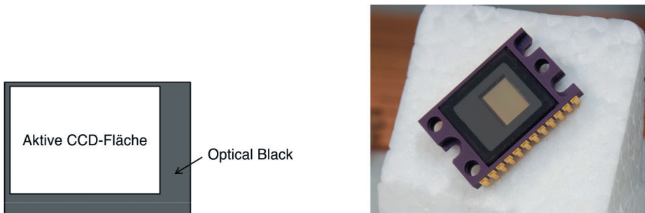
Abb. 22.6 Links: Optical Black. Rechts: CCD-Bildwandler einer professionellen Studiokamera (Philips LDK-Serie); der Chip ist ungefähr so groß wie ein 10 Cent-Stück
