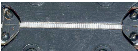
◉ Abb. 9.3 Bändchen eines historischen Bändchenmikrofons (Siemens & Halske).
