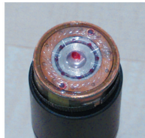
• Abb. 9.5 Prinzip eines Tauchspulenmikrofons und Kapsel eines Shure SM57.
