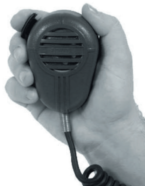
• Abb. 9.1 Links: Historisches Kohlemikrofon (Reisz Marmorblockmikrofon). Rechts: Aktuelles Kohlemikrofon (Shure 104C).
