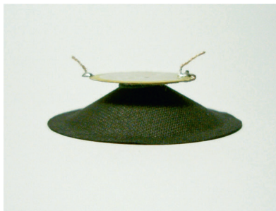
● Abb. 18.9 Piezo-Lautsprecher. Links: Komplettes Hochtוןhorn. Rechts: Ausgebauter Piezowandler (Ø 2 cm) mit aufgeklebter Membran.
