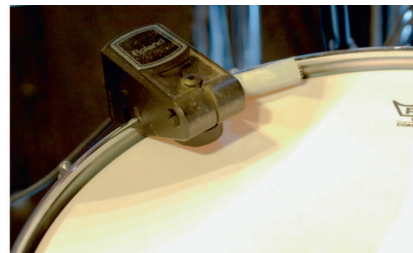
● Abb. 9.10 Links: Piezotonabnehmer unter dem Steg eines Kontrabasses. Rechts: Triggermikrofon an einer Snaredrum.
