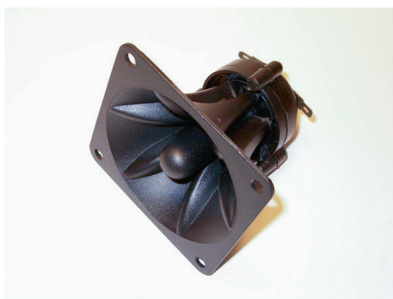
● Abb. 18.9 Piezo-Lautsprecher. Links: Komplettes Hochtוןhorn. Rechts: Ausgebauter Piezowandler (Ø 2 cm) mit aufgeklebter Membran.
