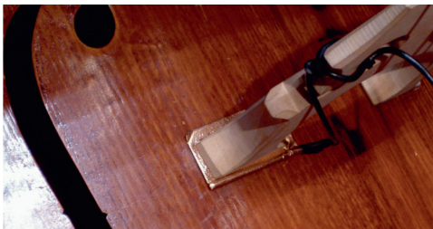
● Abb. 9.10 Links: Piezotonabnehmer unter dem Steg eines Kontrabasses. Rechts: Triggermikrofon an einer Snaredrum.
