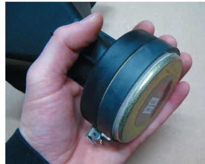
• Abb. 18.5 Links: Prinzip Druckkammerlautsprecher. Rechts: Hochtorn Apogee FT300H.
