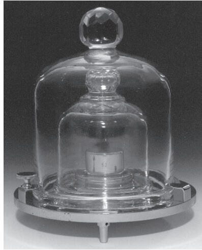
◉ Abb. 1.3 Die verschiedenen Kopien des Urkilogramms in Frankreich – im Bild das Exemplar der PTB – unterscheiden sich inzwischen um einige Mikrogramm; eventuell ist die Ursache zu häufiges Putzen.
