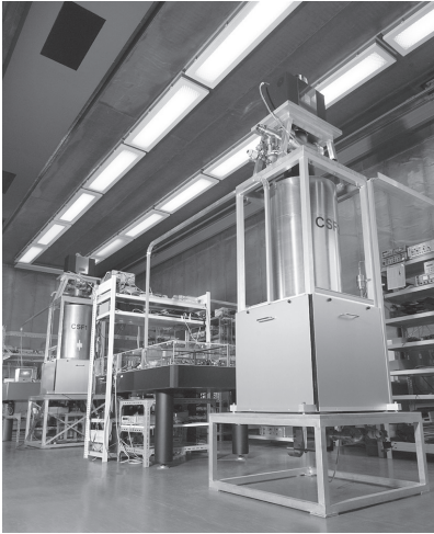
◉ Abb. 1.2 Die Physikalisch-Technische Bundesanstalt (PTB) betreibt Cäsium-Atomuhren zur Steigerung der Präzision im Zwillingbetrieb.
